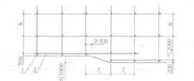
图 6.3.3 纵、横向扫地杆构造 1—横向扫地杆；2—纵向扫地杆
